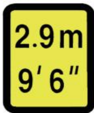
图 E.1 箱高超过 2.6 m 的集装箱高度标记示意图
